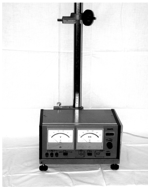
Рис. 9.1. Установка для измерения удельного сопротивления тонкого провода
